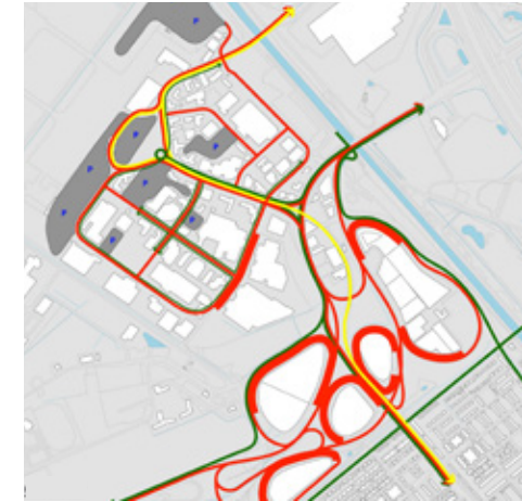
FIGUUR 9 HUIDIGE ROUTING LUCHTHAVENGEBIED (ROOD = AUTO; GEEL = OV; GROEN = LANGZAAM VERKEER) EN GROEN- STRUCTUUR
